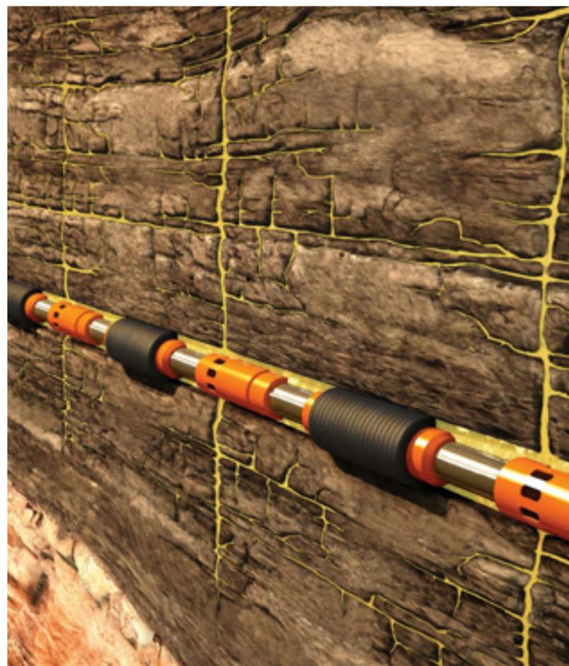
哈里伯顿公司的固井滑套分段压裂系统，主要包括膨胀悬挂器、遇油膨胀封隔器、压裂滑套。
